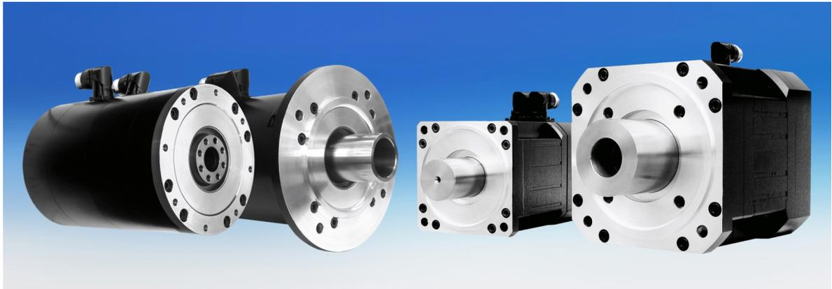
Torquemotoren der Baureihe MH 4 – links MH 41: runde Torquemotoren mit Gehäuse, einmal mit Blockflansch und Hohlwelle und einmal mit Standardflansch und Hohlwelle; rechts MH 42: Torquemotoren mit quadratischem Querschnitt ohne Gehäuse, einmal mit Vollwelle und einmal mit Hohlwelle, beide mit Standardflansch.
