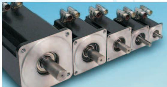
Im Antriebspaket bieten wir mit der Baureihe „MR 7“ Servomotoren mit hoher Leistungsdichte an. Bei Flanschmaßen von 40 bis 188 mm decken diese kompakten Servomotoren einen Drehmomentbereich von 0,4 bis 40 Nm ab.
