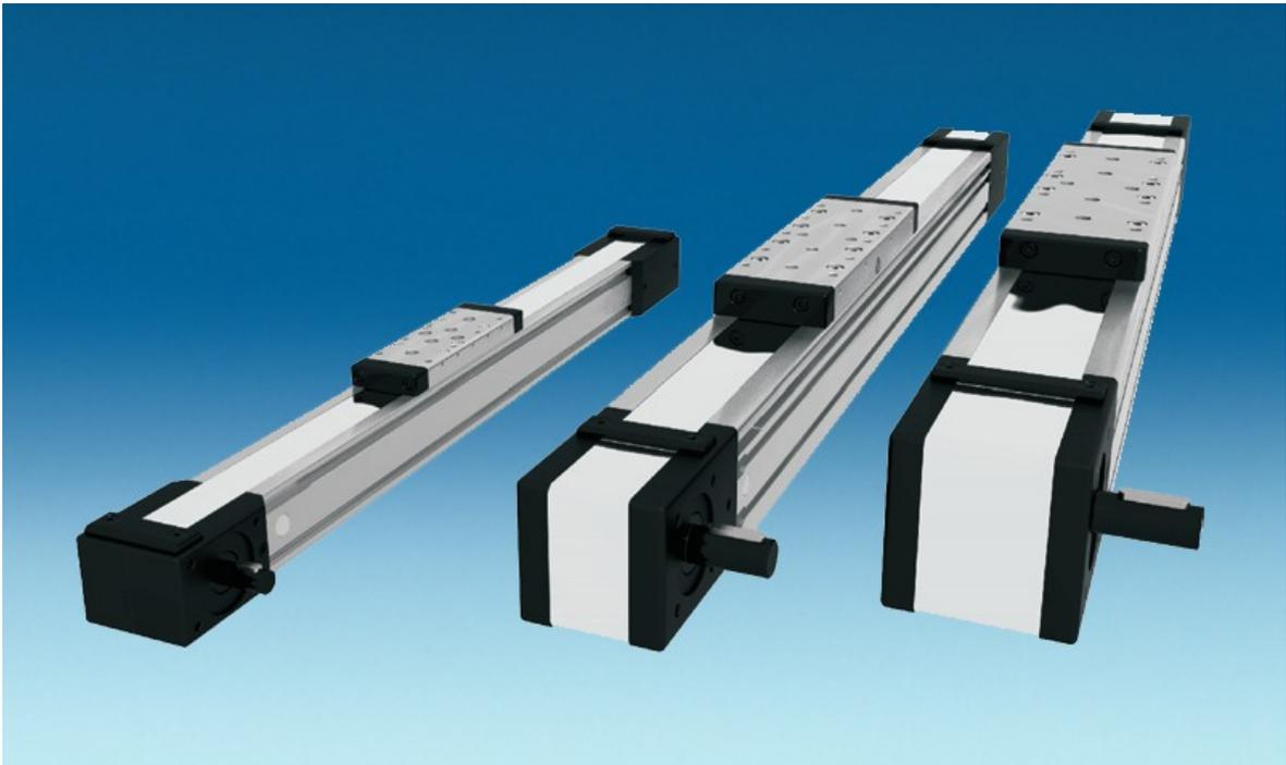
Linearmodule in drei Ausführungen mit je vier Baugrößen, bestehend aus präzisionsgezogenem Aluminiumprofil, Zahnriemenantrieb, Linearführungen und Schlitten. Bis 6 m Profillänge, Geschwindigkeiten bis 10 m/s, Kräfte bis zu 3.250 N, Beschleunigung bis 70 m/s<sup>2</sup>. Auch kombinierbar als Mehrachssysteme, auf Wunsch komplett ausgestattet mit hochdynamischen AC-Servomotoren.
