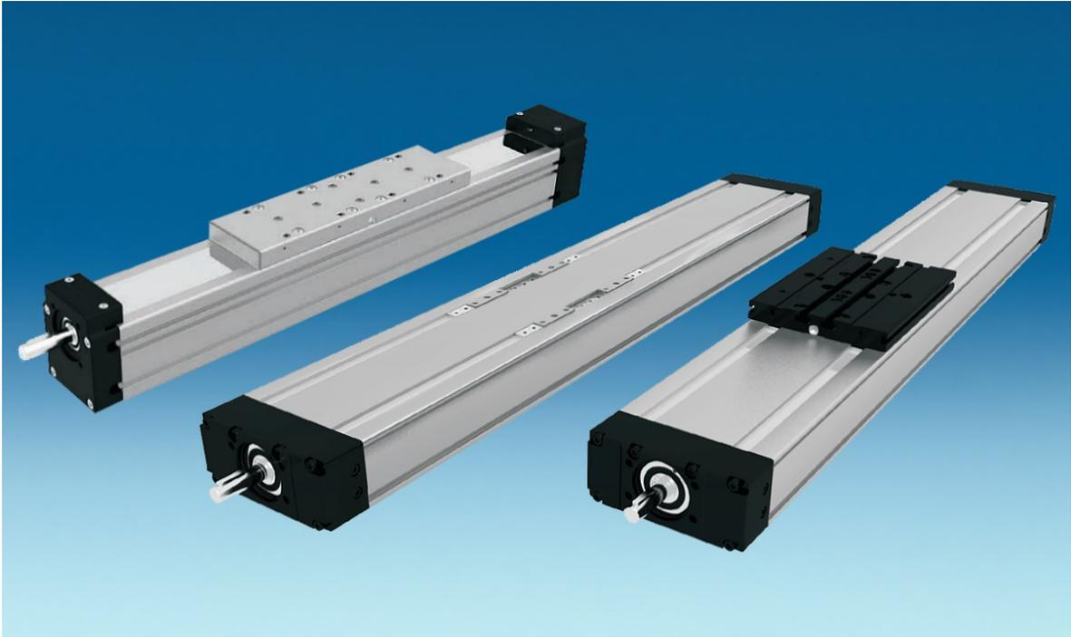
Linearmodule in zwei Ausführungen und insgesamt sieben Baugrößen, bestehend aus präzisionsgezogenem Aluminiumprofil, Präzisions-Kugelgewindetrieb, Linearführungen und Schlitten. Bis 5,8 m Profillänge, Spindelsteigungen von 5 bis 50 mm, Geschwindigkeiten bis 2,5 m/s, Kräfte bis zu 29.600 N, Beschleunigung bis 20 m/s<sup>2</sup>. Auch kombinierbar als Mehrachssysteme, auf Wunsch komplett ausgestattet mit hochdynamischen AC-Servomotoren.
