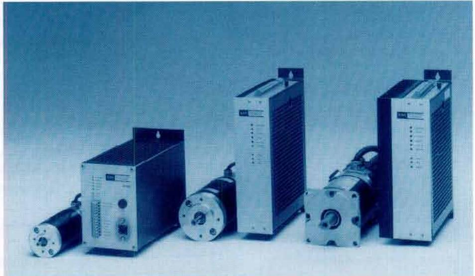
Servoantriebspakete mit Gleichstrom-Motoren, Drehmomente bis 5,5 Nm, Standard-Drehzahlen um 3000 min<sup>-1</sup>. Links ein Kompaktverstärker mit eingebauten Netztransformator (bis 160 Watt), in der Mitte und rechts Kompaktverstärker höherer Leistung (bis 1,4 kW), bei denen der Netztransformator getrennt montiert wird. Jeweils daneben die zugehörigen Servomotoren.
