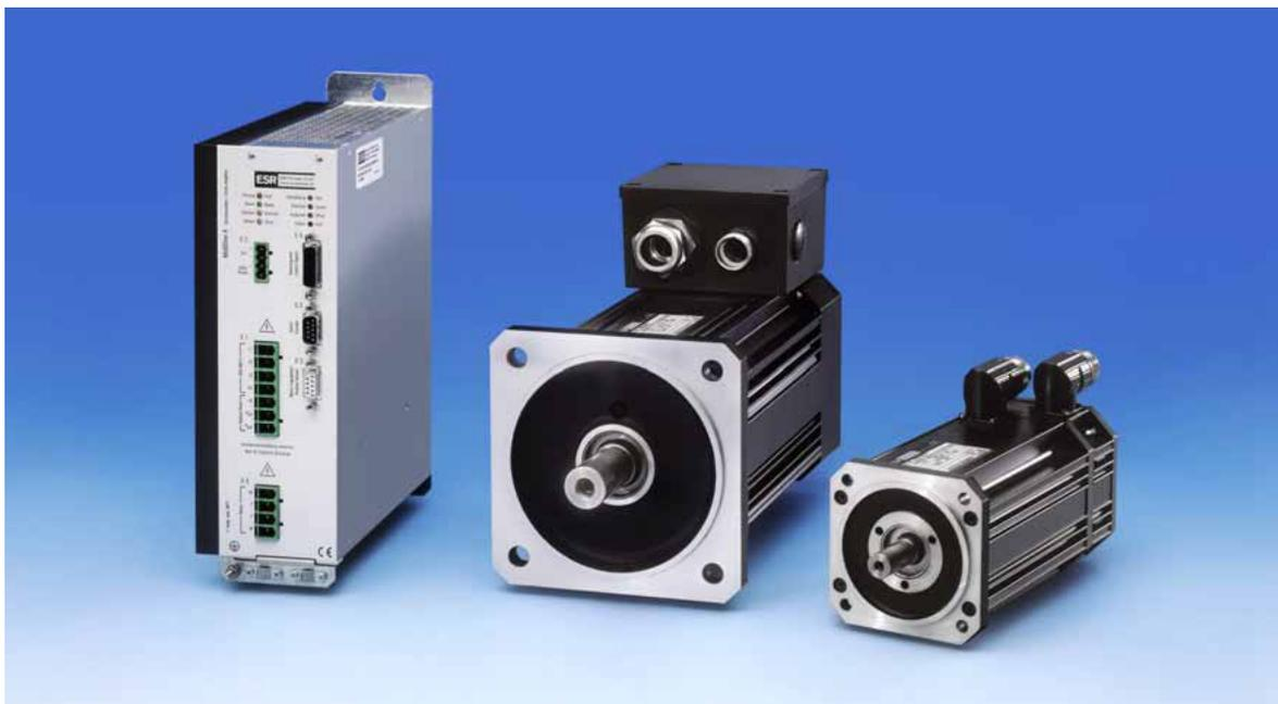
Komponenten der Servoantriebsfamilie MidiDrive A: Servoregler BN 6682 der mittleren Leistungsklasse (4 A,  $U_{Zk} = 560$  V), Motoren MR 7434 (4,0 Nm bei  $6000 \text{ min}^{-1}$ ) und MR 4106 (0,65 Nm bei  $6000 \text{ min}^{-1}$ )
