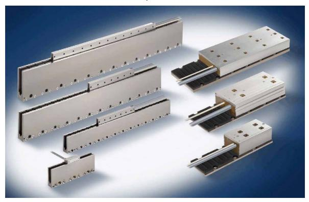
Komponenten der Linearmotorfamilie ML 1: Primärteile (Spulenpakete) und Sekundärteile (Magnetplatten). Links: eisenlose Linearmotoren; rechts: eisenbehaftete Linearmotoren.
