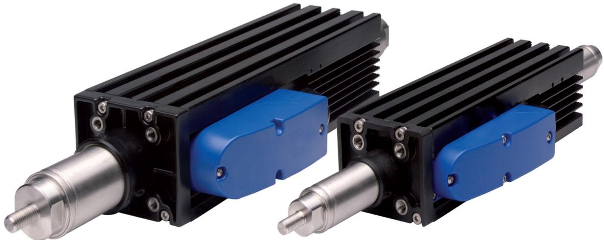
Linearmotor-Aktuatoren der Baureihe ML 71: links ein Aktuator der Baugröße ML 713x (Stangendurchmesser Ø38 mm, bis 1860 N Spitzenkraft), rechts ein Aktuator der Baugröße ML 712x (Stangendurchmesser Ø25 mm, bis 780 N Spitzenkraft)
