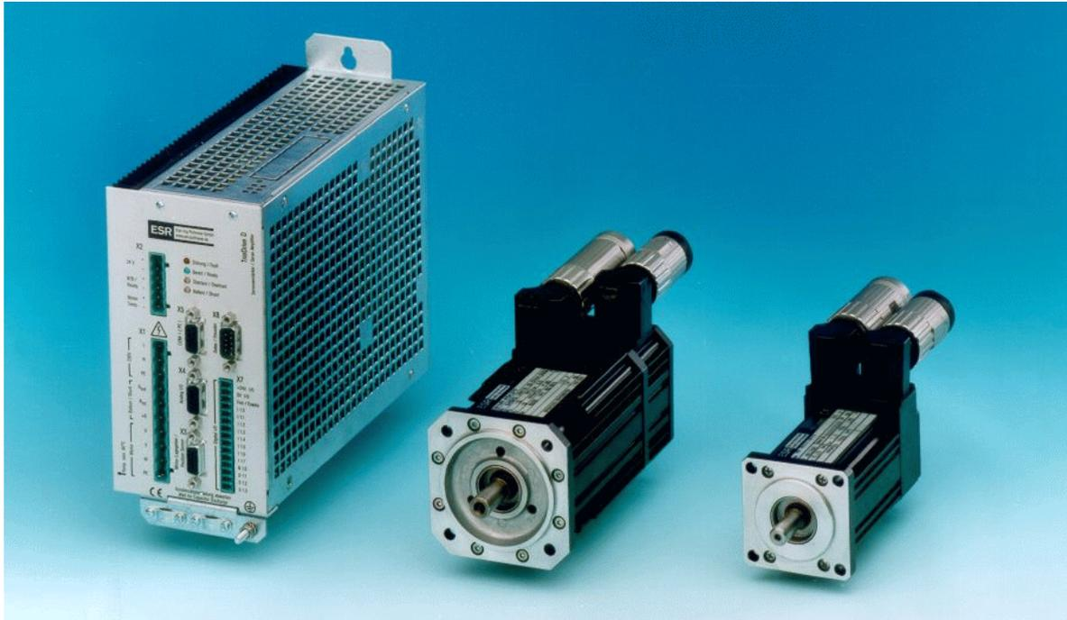
Komponenten der Servoantriebsfamilie TrioDrive D: Servoverstärker BN 6752 der mittleren Leistungsklasse (4 A), Motor MR 4104 (0,5 Nm bei 6000 min<sup>-1</sup>), Motor MR 4030 (0,3 Nm bei 6000 min<sup>-1</sup>)
