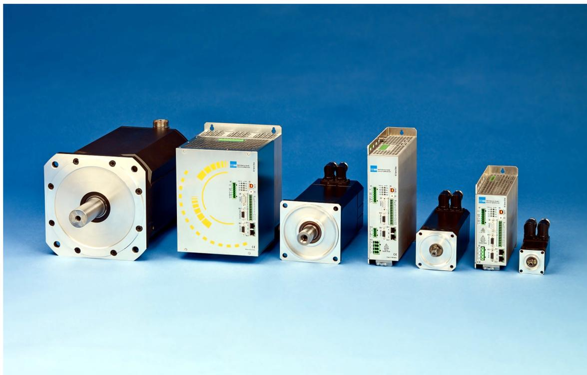
Komponenten der Servoantriebe neue Generation: Servoregler in drei Baugrößen, links: bis 32 A Nennstrom; Mitte: bis 8 A Nennstrom (beide 3 × 400/480 V); rechts: bis 6 A Nennstrom (230 V); dazu Servomotoren MR 74, erhältlich in acht Baugrößen (Flanschmaß 37 bis 240 mm), Nenndrehmoment 0,1 bis 70 Nm, Nenndrehzahl bis 6.000 min<sup>-1</sup> (weitere auf Anfrage)
